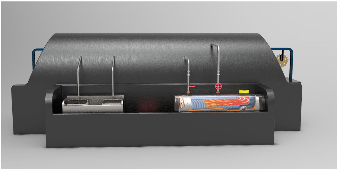
Imagen 2.7 prototipo final, lado de caldera y depósito de pintura
