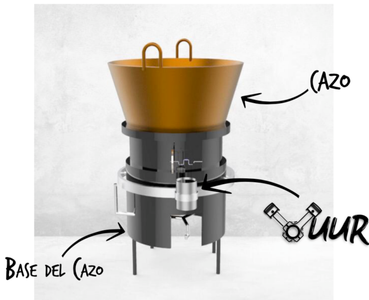
Fig. 4. Modelado 3D del motor y su ajuste a la olla
