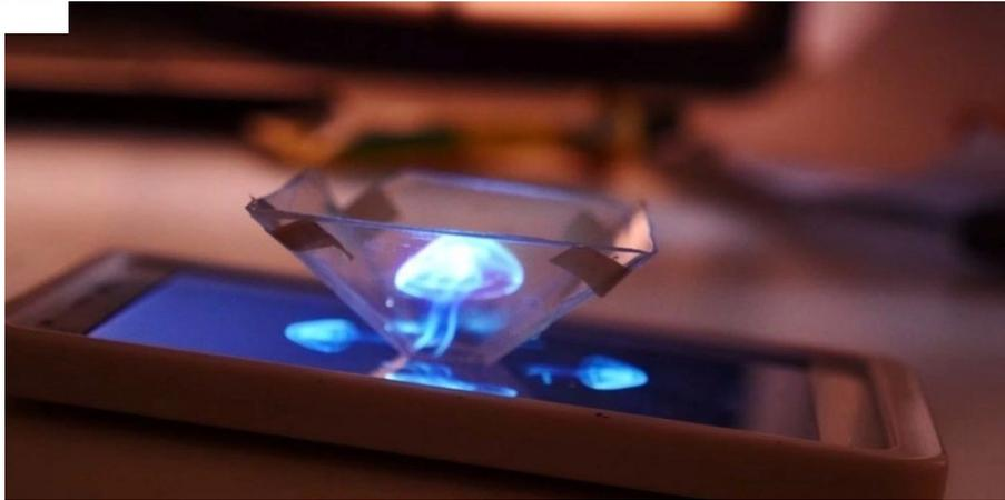
Pensamos tener un video especial que se repite y se reproduce al mismo tiempo debajo de cada cara del prisma, entonces la imagen va a ser unida por medio de una ilusión óptica creando una imagen tridimensional. Ahora lo que teníamos en mente es la creación de un
