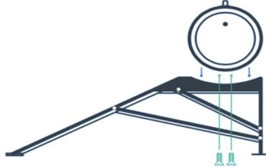
**Fig. 13 Esquema de instalación de termo tanque.**
