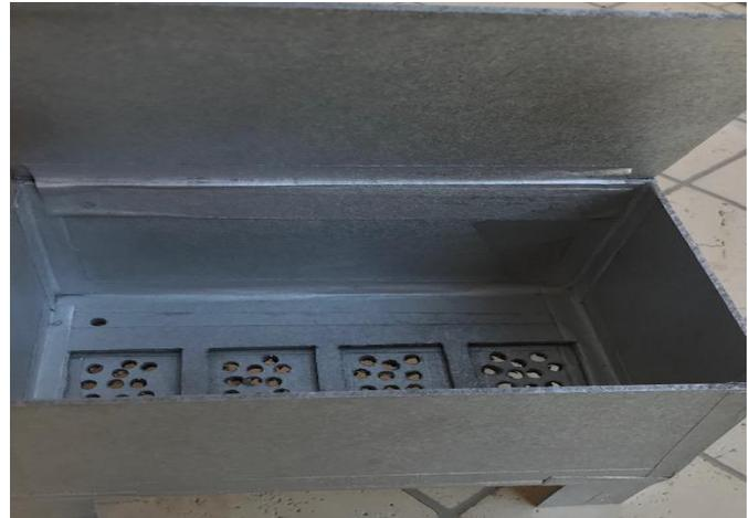
El cual se le añadió a la base en la parte superior una caja, en donde se va a meter el gel congelante, o hielo seco o nitrógeno líquido para generar la diferencia de temperaturas que necesitamos, además se le agregaron a los cables de la celda plástico thermofit el cual fungirá como un aislante térmico, que evitará que el cable se dañe.
