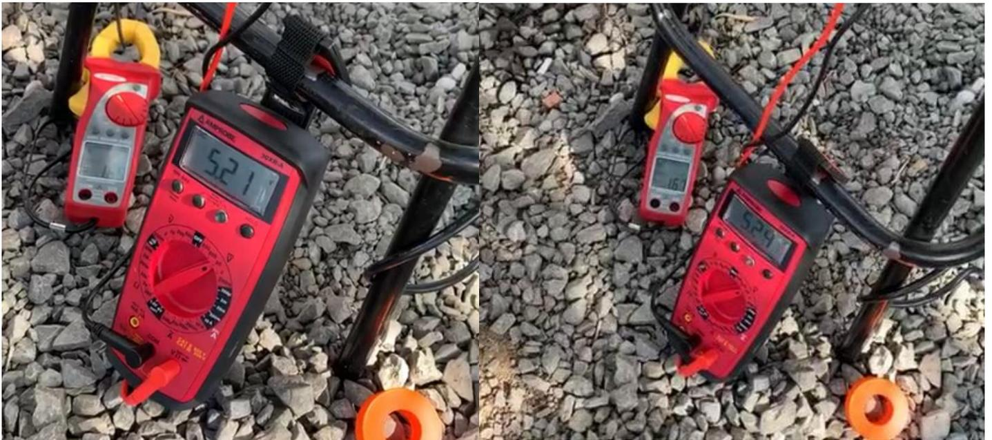
Se determinaron las pruebas correspondientes, para saber si la bomba de agua trabaja al voltaje adecuado y verificar el funcionamiento.
